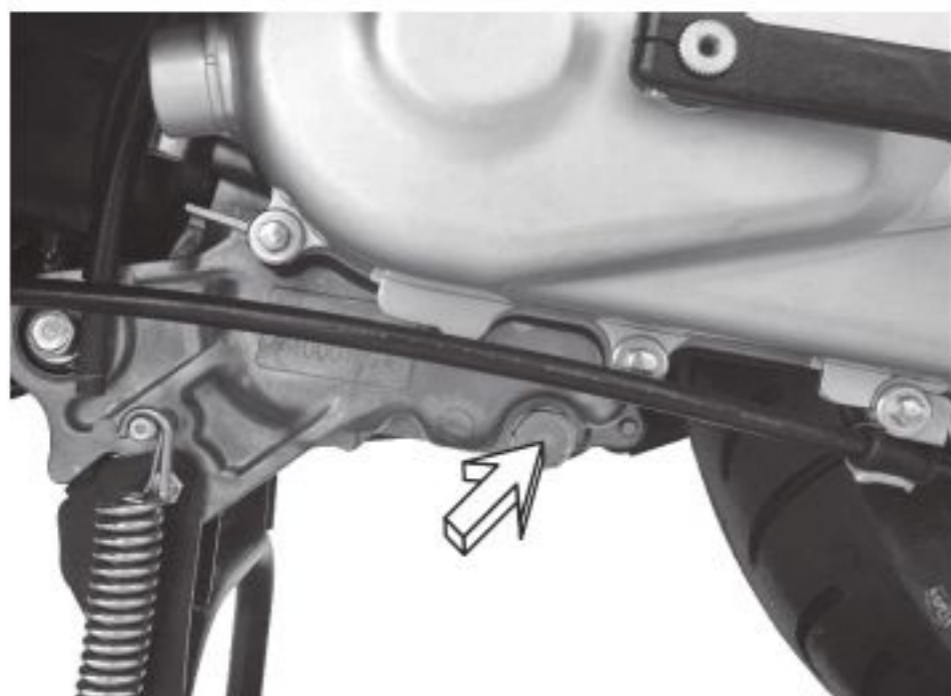
Vite di drenaggio
